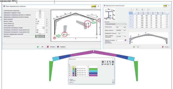
Рис. 8. Возможности моделирования рам переменного сечения (SCAD++)
