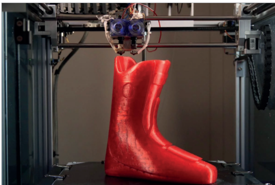
Лыжные ботинки от компании Tailored Fits — пример массовой кастомизации, реализованной благодаря 3D-печати
