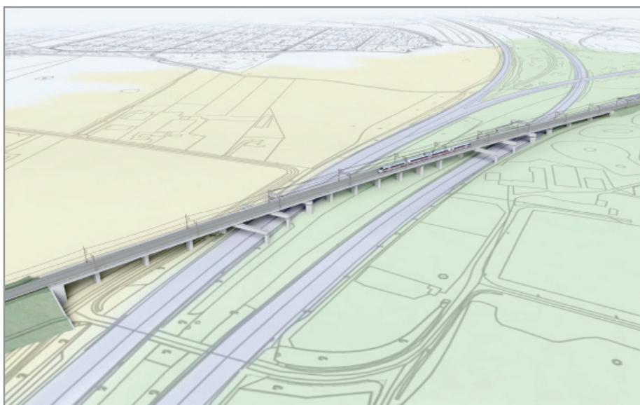
Banedanmark строит самую быструю железную дорогу Дании: на 60-километровой двухпутной электрифицированной железнодорожной магистрали поезда будут развивать скорость до 250 километров в час
