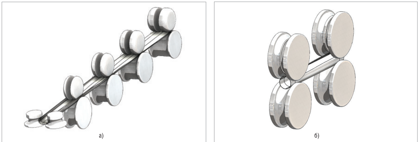
Рис. 2. Группа валков открытого (а) и закрытого (б) типа
