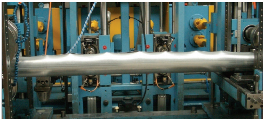
Рис. 1. Гофра на кромке трубы
