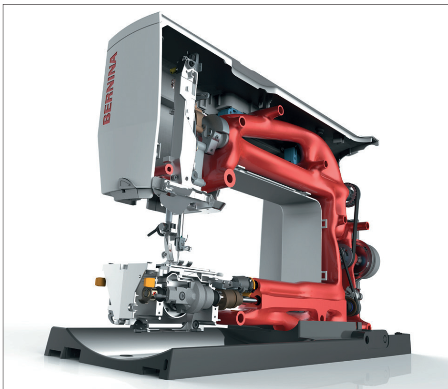
Результат оптимизации несущей рамы швейно-вышивальной машины Bernina B880
