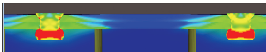
Рис. 3. Напряжения в листе, стрингере и заклепках
