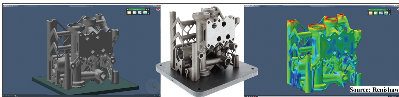
Рис. 8. Компьютерное моделирование изготовления металлической детали на 3D-принтере
