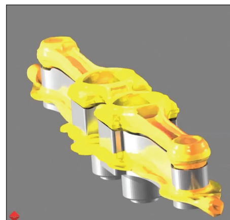
Реальный процесс получения изделия путем объемной штамповки (слева) и реализация процесса в виртуальном пространстве Simufact.forming (справа)
