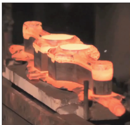
Реальный процесс получения изделия путем объемной штамповки (слева) и реализация процесса в виртуальном пространстве Simufact.forming (справа)
