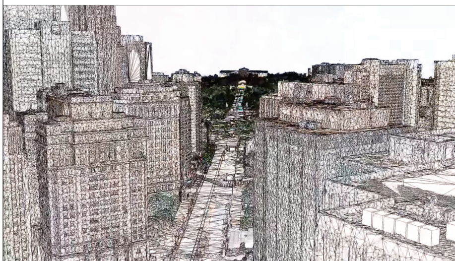
Создание 3D-модели Филадельфии с помощью Context Capture при подготовке к визиту Папы Римского
