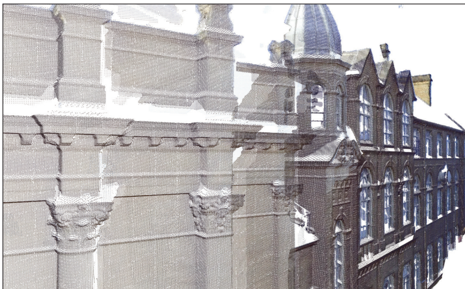
ARCHICAD 19 поддерживает работу с облаками точек, получаемыми при помощи лазерного 3D-сканирования
