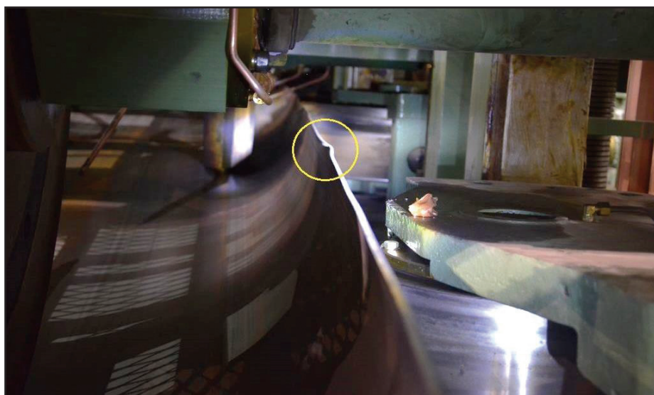
Рис. 4. Образование излома в межклетьевом пространстве
