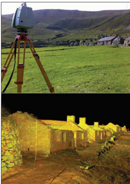
Рис. 1. Облака точек получаются в результате 3D-сканирования объектов 1
