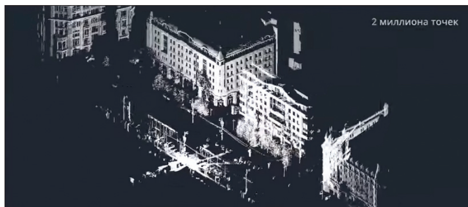
Рис. 11. Облака точек в nanoCAD Plus 7
