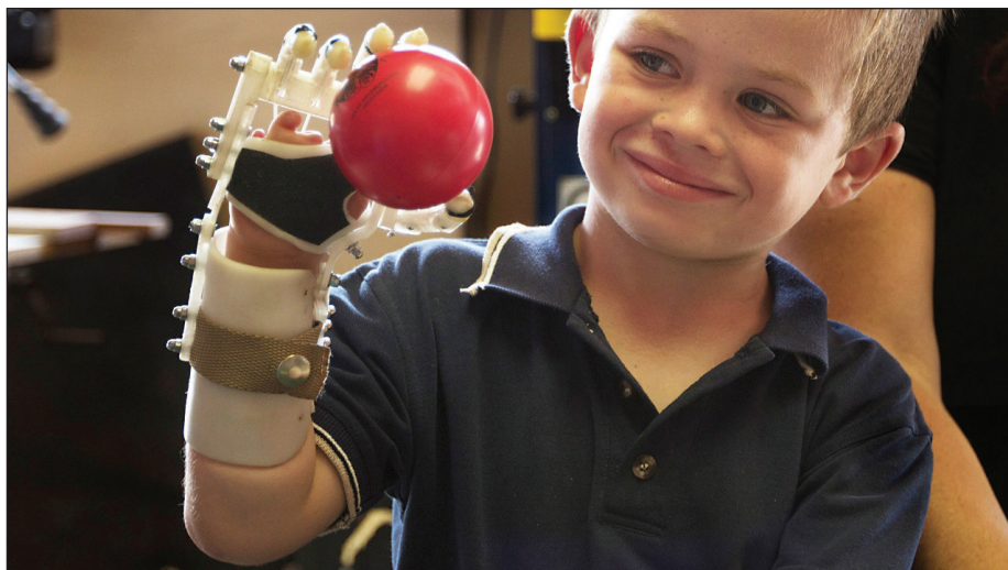
Протез руки Robohand, созданный с помощью 3D-принтера MakerBot, – альтернатива обычному дорогому протезированию
