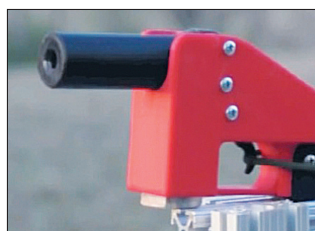
Первые испытания пистолета. Спусковой механизм приводится в действие дистанционно
