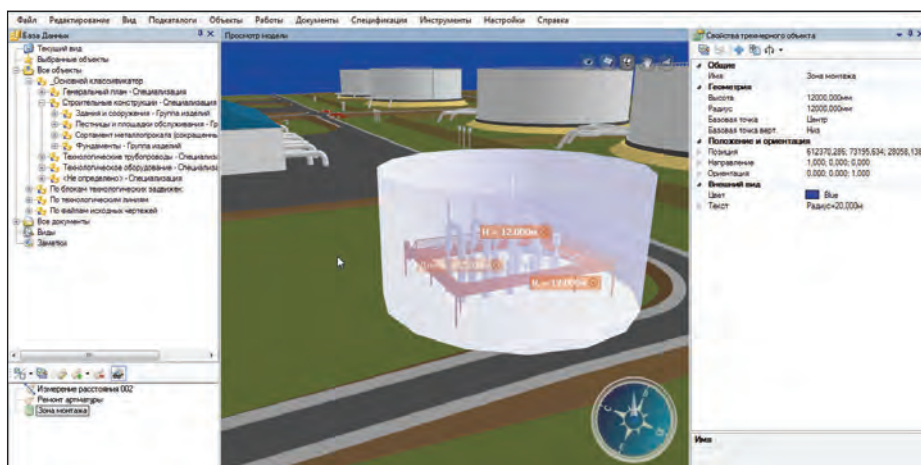
Рис. 3. Применение дополнительных измерительных геометрических тел позволяет имитировать зоны монтажа оборудования, а также развитие чрезвычайных ситуаций
