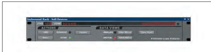
Рис. 14. Панель управления логическим анализатором
