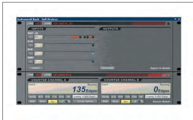
Рис. 10. Панель виртуальных инструментов отладки. В панели виртуального цифрового модуля световыми индикаторами отображаются логические уровни сигналов на внутренних узлах ПЛИС и выходных контактах. Одновременно в левой части поля SQ[7..0] выводится шестнадцатеричное число, показывающее состояние разрядов регистра
