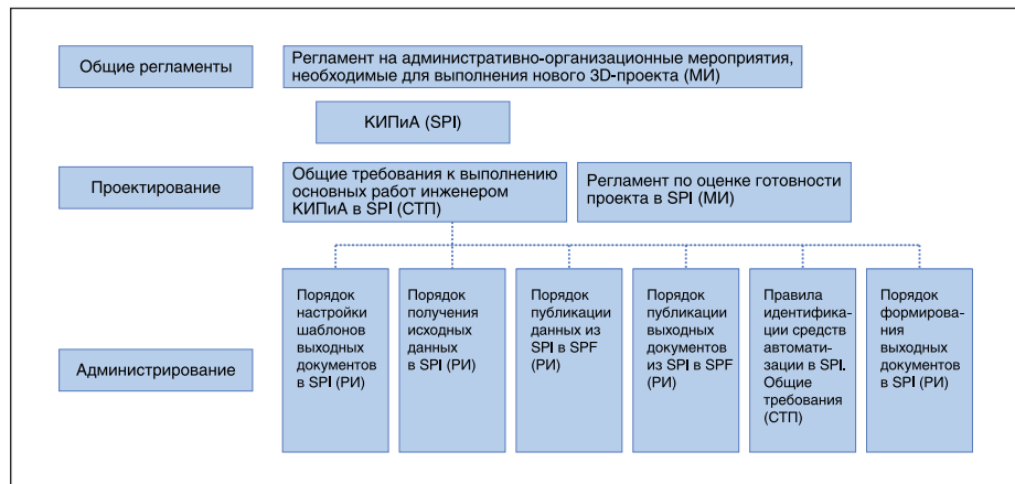
Рис. 4. Пример структуры документации третьего и четвертого уровня по проектированию КИПиА с применением SmartPlant Instrumentation
