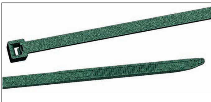
Рис. 1. Конечно-элементная модель детали "Хомутик" (фрагменты)
