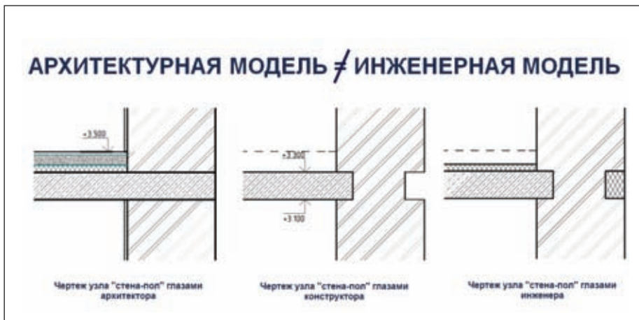
Рис. 1. Многообразие BIM-моделей: здание в представлении различных специалистов различно
