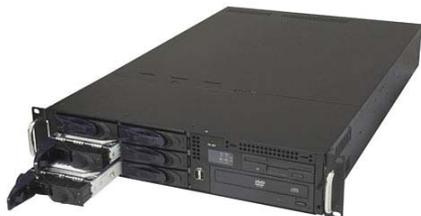
Core2Duo и высокопроизводительные 1U- и 2U-двухпроцессорные серверы на 2xIntel Quad-Core Xeon-1333 МГц FSB для монтажа в 19-дюймовую стойку.
