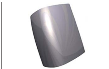
Рис. 5. Блик на модели с G1-непрерывностью
