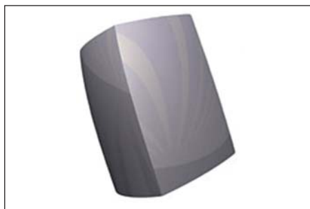
Рис. 4. Блик на модели с G0-непрерывностью
