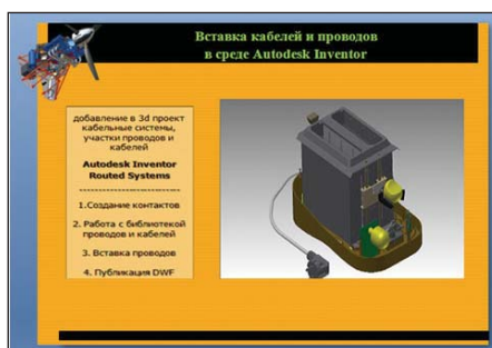
Рис. 4. Моделирование вставки кабелей и проводов в тостер
