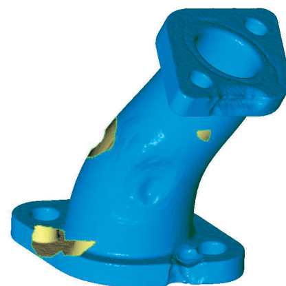
Рис. 5. Дефекты модели и неточности сканирования
