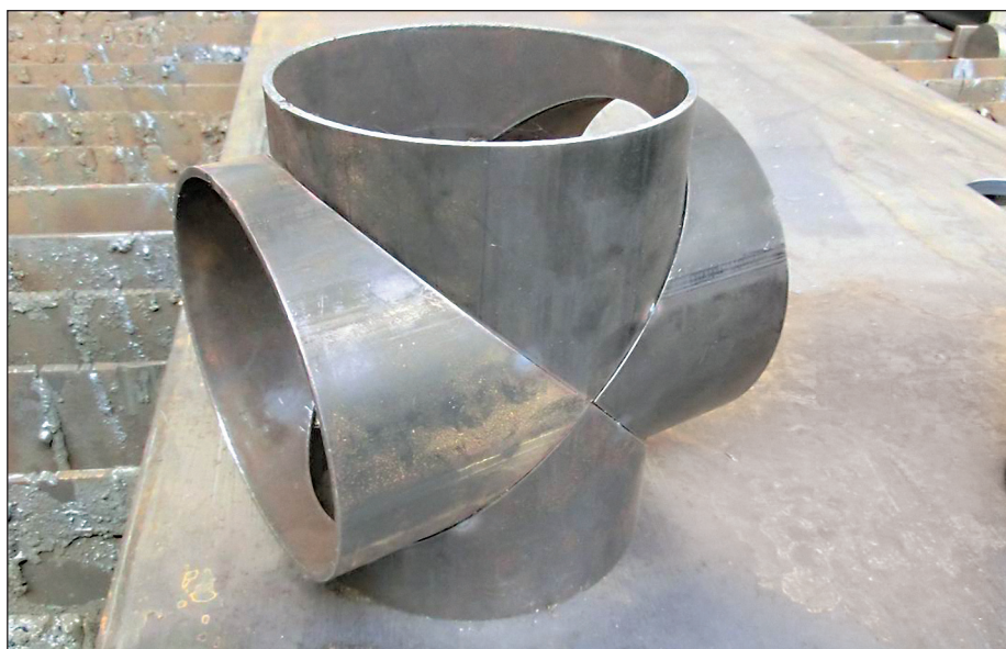
Рис. 5. Сопряжение труб
