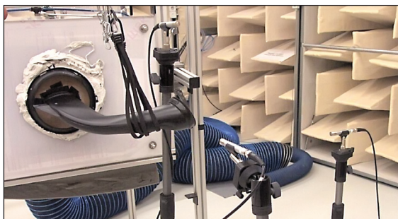
Рис. 8. Испытательная установка в полубезэховой камере. На установке закреплен боковой воздухопровод. Источник: Visteon [2]
