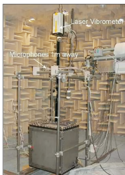
Рис. 4. Вибростенд и безэховая камера для виброиспытаний панели звукопоглощающего материала [1]
