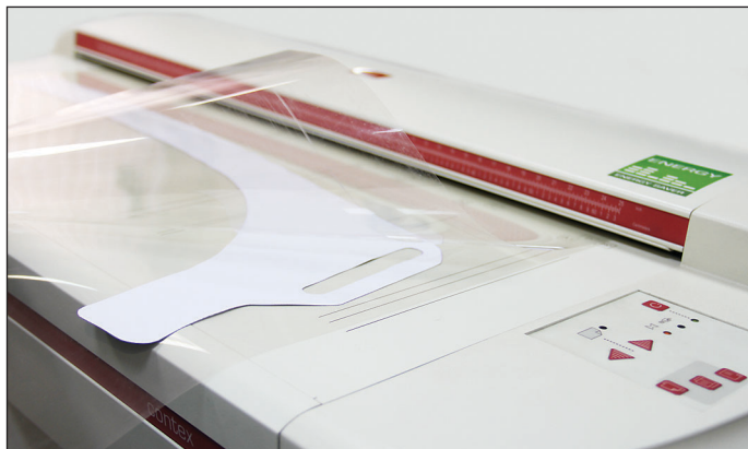
Рис. 1. Сканирование лекала на широкоформатном протяжном сканере Contex
