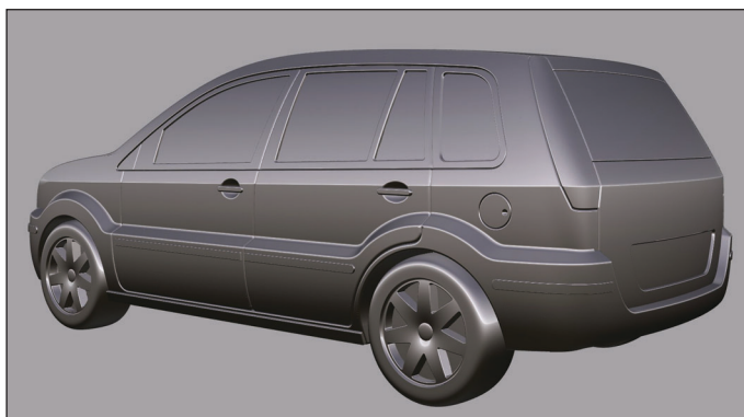
Рис. 8. Поверхностная модель экстерьера автомобиля, выполненная в Autodesk Alias
