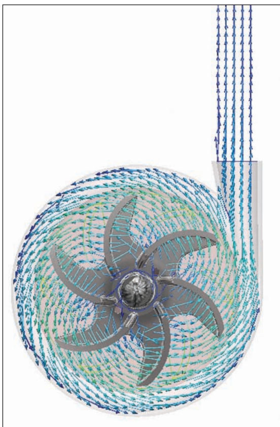
Векторное распределение скорости в проточной части центробежного насоса
