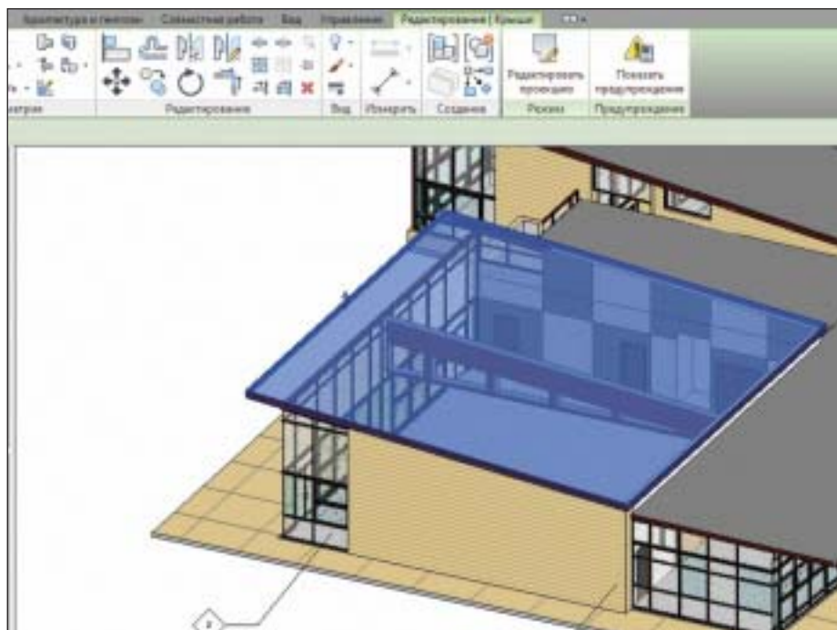
Рис. 3. Режим маркировки элементов на 3D-виде, а также возможность полупрозрачного отображения выделенных элементов
