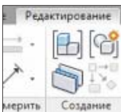
Рис. 8. Функции создания сборки (левая верхняя кнопка) и создания детали (левая нижняя кнопка)
