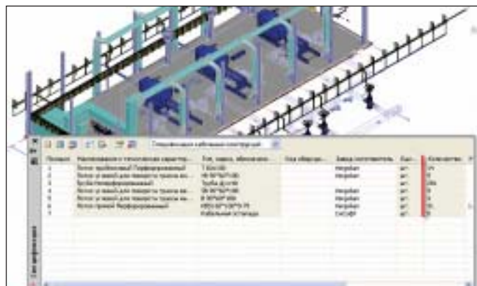
Рис. 5. Заказная спецификация на кабельные конструкции
