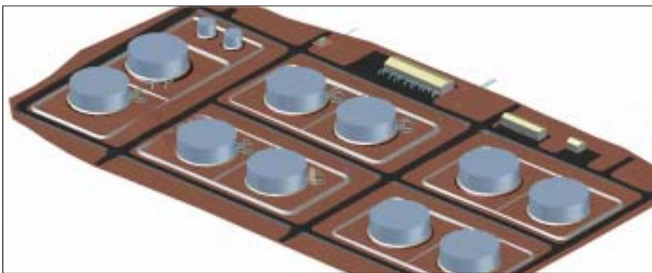
Трехмерная модель резервуарного парка нефтетерминала, выполненная в Model Studio CS Трубопроводы
