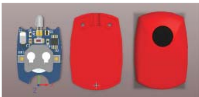
Рис. 93. Расположение механических деталей корпуса
