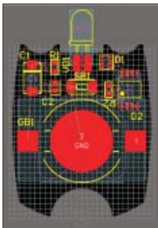
Рис. 78. Расположение компонентов
