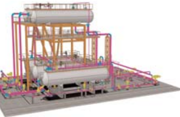
Блок сепараторов, выполненный в Model Studio CS
