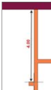
Рис. 4. Рисование стен при помощи команды Отсчет
