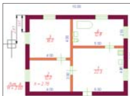
Рис. 11. Вставка окон с отсчетом
