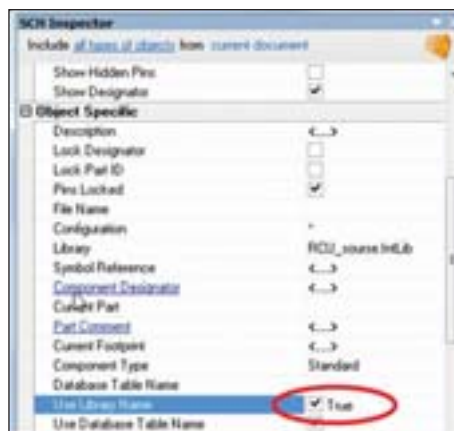
Рис. 60. Настройка компонентов схемы
