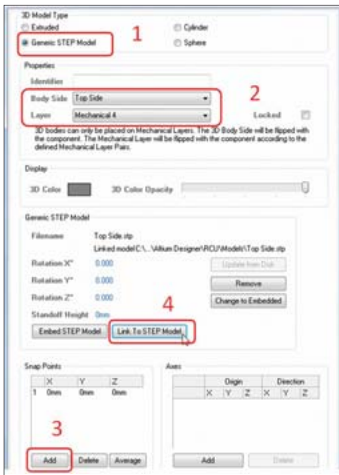
Рис. 56. Подключение STEP-модели
