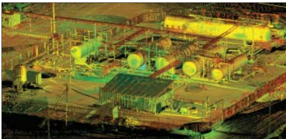
Результаты лазерного сканирования технологических установок обустройства месторождений
