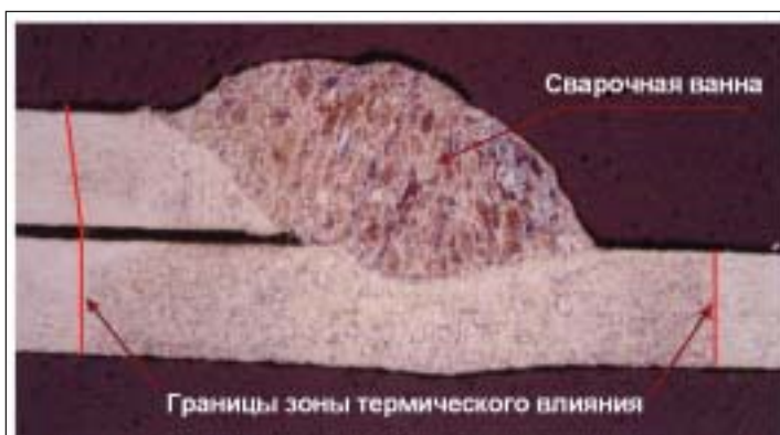
Рис. 6. Макрошлиф поперечного сечения сварного соединения внахлест
