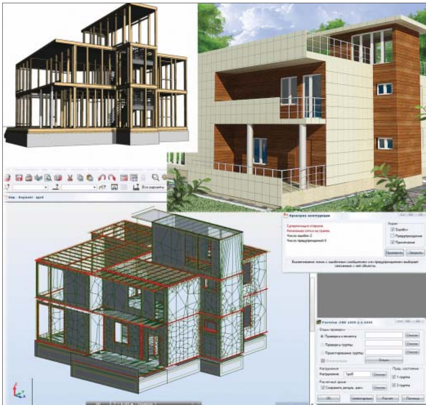
Рис. 1. Ксения Собачкина. Проект дома из SIP-панелей. Учебная работа. Использовались программы Revit Architecture и Revit Structure, конструктивные расчеты выполнены в Robot Structural Analysis (внизу показана стадия выявления ошибок в модели). НГАСУ(Сибстрин), 2010
