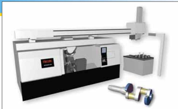
**И**митация работы станка средствами системы **VERICUT** позволяет обнаружить столкновения и опасные сближения с любыми компонентами оборудования, такими как направляющие, инструментальные шпиндели, револьверные головки, поворотные столы, устройства смены инструмента, крепежные приспособления, заготовки, режущий инструмент, другие определенные пользовате-
