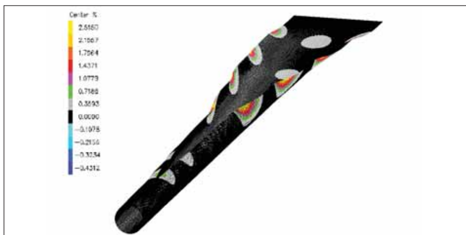
Рис. 7. Напряженно-деформированное состояние при постоянной точке – центре тяжести
