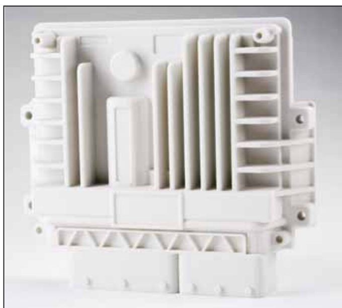
Модель корпуса, изготовленная на Z150
