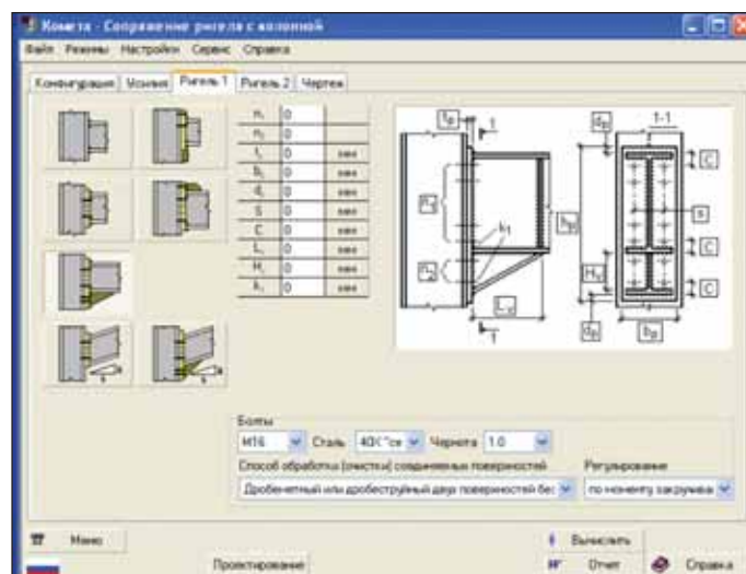
Рис. 9. Интерфейс режима "Сопряжение ригеля с колонной" программы КОМЕТА (жесткое сопряжение)
