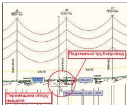
Рис. 11. Перемещение опоры дальше от подземного трубопровода
