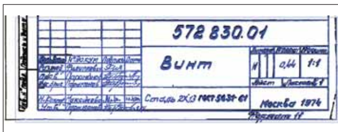
Рис. 20. Наложение штампа на реставрируемый чертеж
