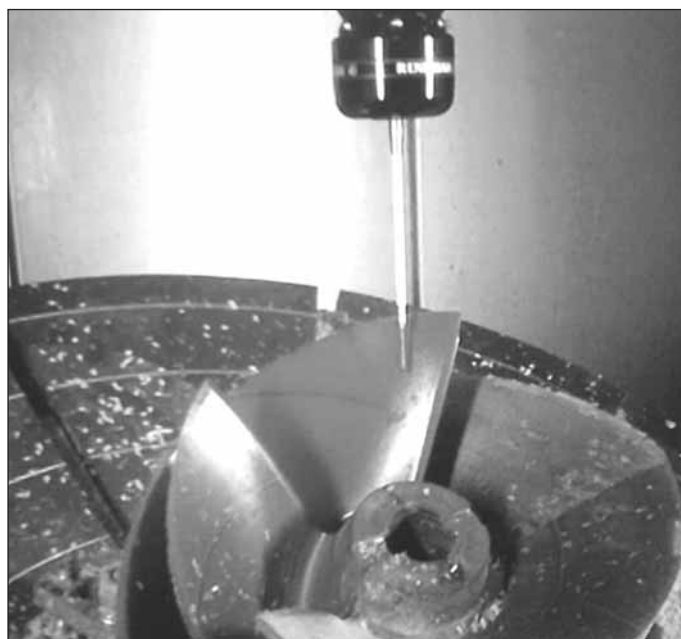
Рис. 11. Реальное измерение колеса датчиком Renishaw
