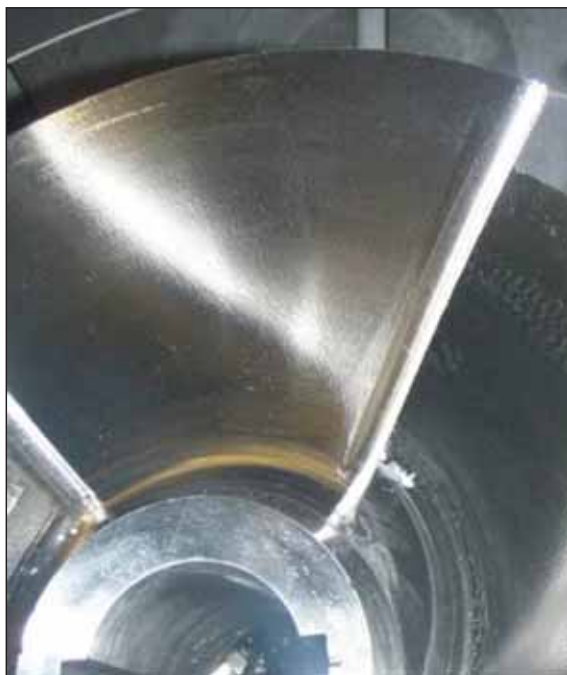
Рис. 8. Чистовая обработка лопатки
