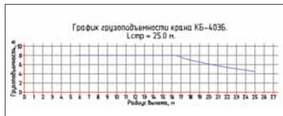
Рис. 9. График грузоподъемности крана, создаваемый программой
