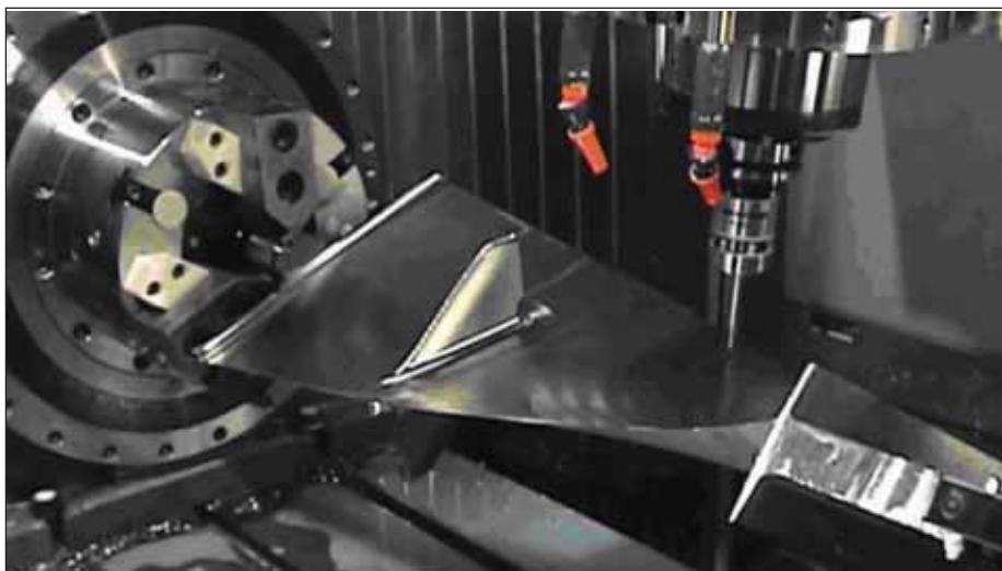
Рис. 4. Контроль обработанной лопатки непосредственно на станке
