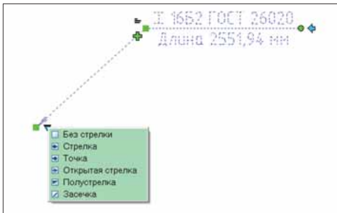
Рис. 2. Простановка выноски и редактирование с помощью "ручек"
