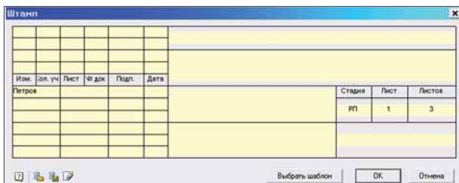
Рис. 8. Пример диалогового окна заполнения штампа в nanoCAD СПДС
