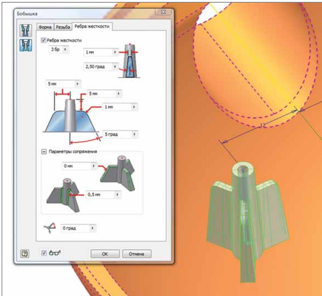
статочно обширен: помимо контура, ограничивающего размеры решетки и ребер жесткости, есть возможность настроить параметры построения "островка", лонжеронов и углов уклонов.
