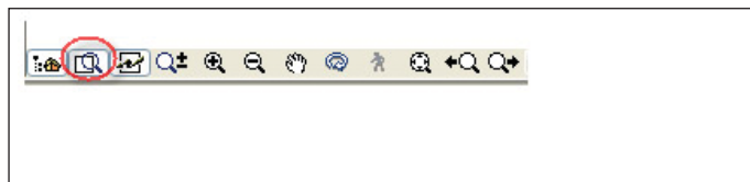
Рис. 4. Планшет навигатора (Navigator Preview) можно открыть, щелкнув на второй кнопке слева, расположенной в левом нижнем углу окна
