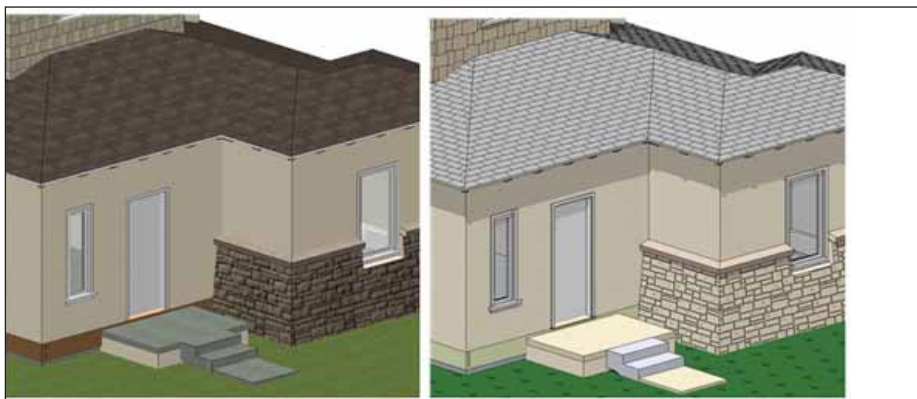
Рис. 11. Режим OpenGL, в отличие от внутреннего механизма визуализации, отображает текстуры и работает более быстро. Но внутренний механизм визуализации ближе к чертежам - он отображает векторную штриховку для поверхностей и строит тени от солнца
