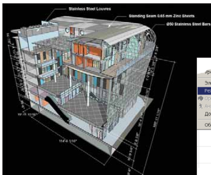
Рис. 1. Результат работы нового инструмента ArchiCAD 12 — 3D-документ
